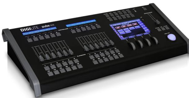
Le operazioni di editing si svolgono attraverso le 4 ruote encoder (per l'accesso ai parametri Palette e l'assegnazione dei valori nei programmi), una track ball per il controllo Pan/Tilt (e pulsanti di Fine/Lock), GrandMaster fader e DBO.
